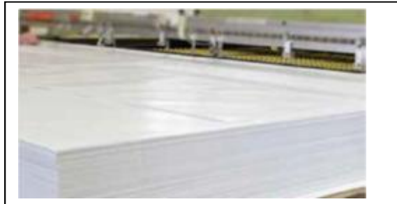
PRODUCTO EN HOJAS ACONDICIONADO Y COLOCADO EN PLANO DURANTE SU IMPRESION (FIG.3)
