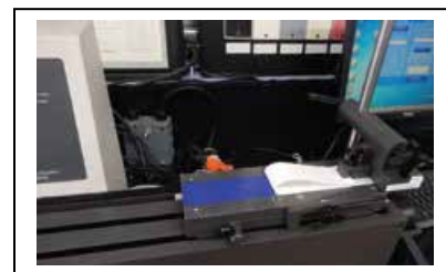
Prueba de liberación del liner a baja velocidad a 180°
